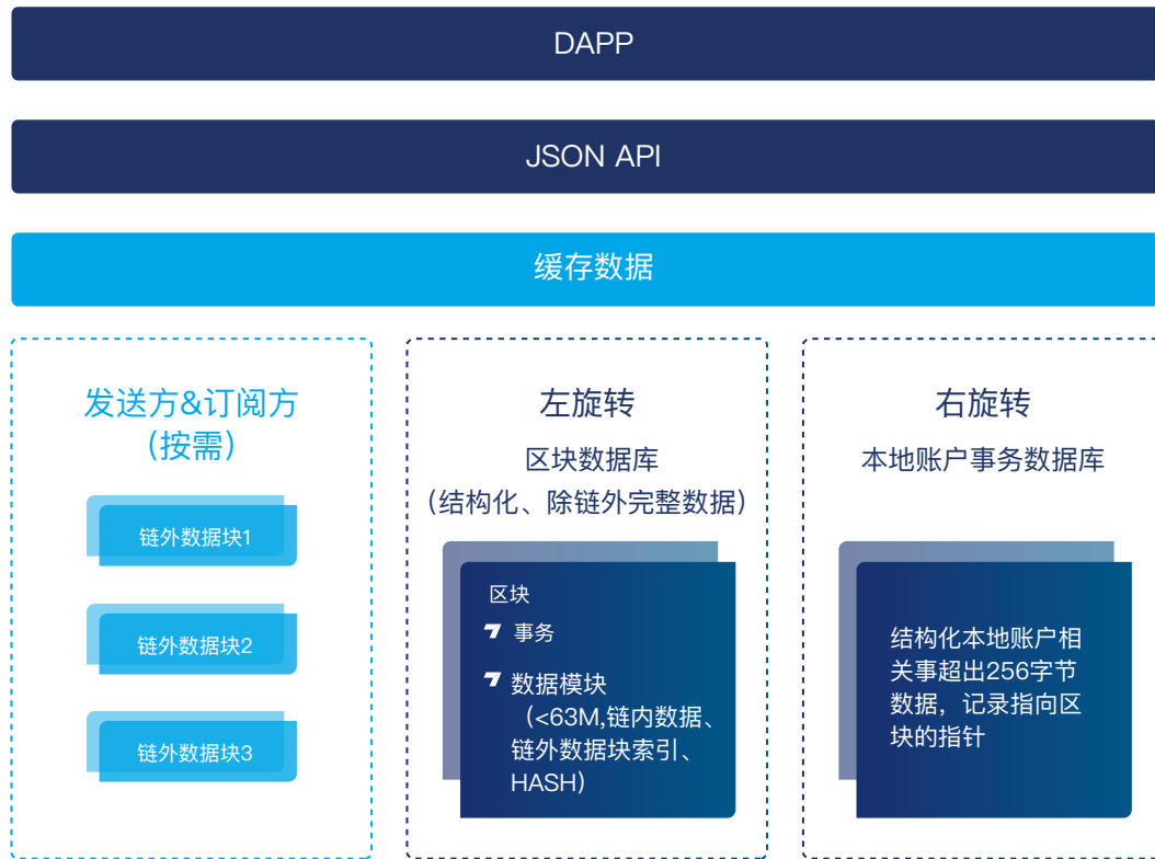
(Timo底层数据存储实现结构图)
